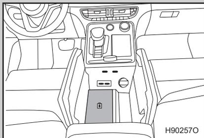
Телефоны, поддерживающие стандартную беспроводную зарядку Qi, можно зарядить непосредственно в зоне для беспроводной зарядки.
