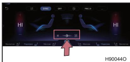
Метод I: нажмите кнопку регулировки скорости работы вентилятора на дисплее или перетаскивайте панель настройки скорости потока воздуха, чтобы отрегулировать скорость потока воздуха всей системы кондиционирования автомобиля от 1 до 7 уровня.
