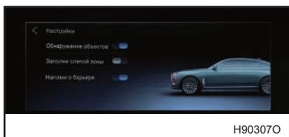
Громкость Предупреждение о препятствии на низкой скорости можно настроить в интерфейсе «Видео» информационно-развлекательной системы.
