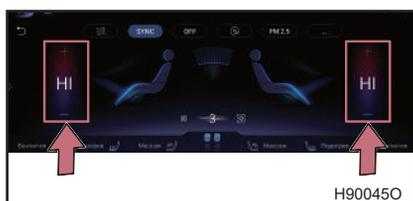
Метод I: коснитесь кнопки настройки температуры дисплея со знаком + (увеличение температуры) или со знаком – (уменьшение температуры), чтобы установить температуру, или можете перемещать значение отображения температуры вверх и вниз, чтобы установить температуру.
