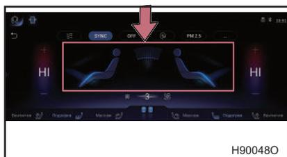
Метод I: нажмите кнопку настройки направления потоков воздуха на интерфейсе или перетаскивайте панель настройки направления потоков воздуха, чтобы отрегулировать направление потока воздуха.
