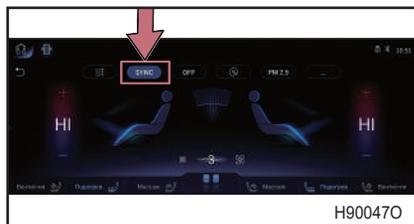
При касании кнопки SYNC загорается индикатор и включается режим управления одной температурной зоной, при этом зона со стороны пассажира и задняя зона синхронизируются с температурой и режимом потока воздуха, установленными на стороне водителя.
