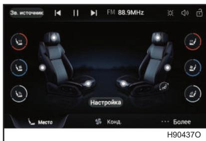
Соответствующую функцию обогрева и вентиляции можно выбрать с помощью дисплея в заднем центральном подлокотнике.
