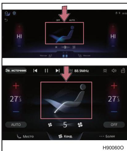
Можно выбрать соответствующий режим направления потока воздуха; при повторном нажатии можно отменить данный режим направления потока воздуха.
