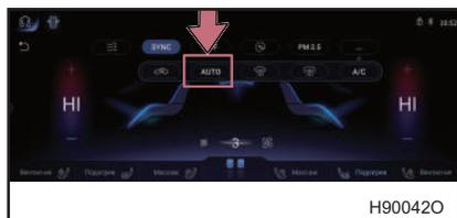
Метод I: нажмите кнопку AUTO в дополнительных функциях дисплея, загорится индикатор работы, и будет введен автоматический режим кондиционирования.
