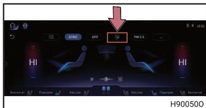
Нажмите кнопку ионизации воздуха на дисплее, индикатор и функция ионизации воздуха включены; снова нажмите, индикатор и функция ионизации воздуха выключены.
