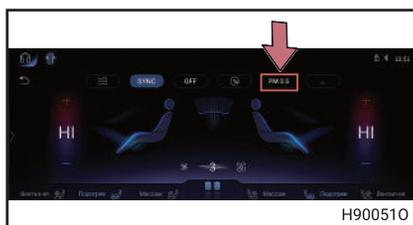
Коснитесь клавиши на дисплее PM2.5, индикатор загорается, начинается контроль концентрации загрязнения воздуха в автомобиле. После завершения теста, если концентрация соответствует стандарту, система автоматически завершит работу; в случае несоответствия система автоматически выполнит фильтрацию и автоматически завершит работу после завершения фильтрации.
