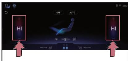
Коснитесь кнопок настройки температуры на переднем/заднем дисплее со знаком + (увеличение температуры) или со знаком - (уменьшение температуры), чтобы установить температуру.
