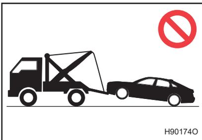
Не используйте подъемные грузовые тележки буксировки во избежание повреждения кузова.
