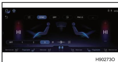
Нажмите на передний развлекательный дисплей с интерфейсом управления подогревом и вентиляцией сидений, чтобы выбрать соответствующий режим.
