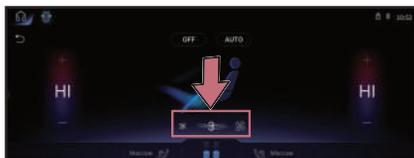
Используйте кнопки настройки скорости потока воздуха на переднем/заднем дисплее для регулировки объема воздуха системы кондиционирования от 1 до 7 уровня.
