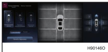
Поиск парковочных мест выполняется в автоматическом или ручном режиме. Для каждого режима имеются три типа парковочных мест: вертикальная парковка, наклонная парковка и горизонтальная парковка.
