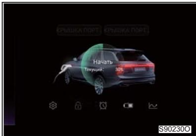
Когда автомобиль находится в состоянии ожидания регулярной зарядки, при нажатии кнопки [Начать] на интерфейсе зарядки в информационно-развлекательной системе автомобиля сразу начнется зарядка переменным током без необходимости выключать переключатель регулярной зарядки.
