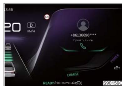
При нажатии кнопки телефона на рулевом колесе отображается номер последнего вызова, а при повторном нажатии выполняется набор номера. При длительном нажатии сразу набирается номер последнего вызова.
