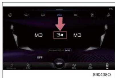
Способ 1: проведите вверх или вниз по значению настройки объема воздуха на дисплее управления передним кондиционером, чтобы установить объем воздуха в системе кондиционирования третьего ряда на уровне от 1 до 5.
