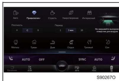
После выбора подходящего ароматизирующего режима система будет работать вместе с кондиционером для улучшения внутренней среды автомобиля и повышения комфорта водителя и пассажиров.
