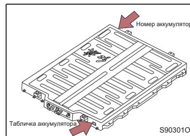
Как показано на рисунке, номер аккумуляторной батареи и ее табличка расположены на корпусе аккумуляторной батареи.
