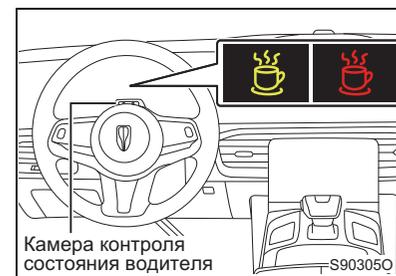
Когда система определяет, что состояние водителя в текущий момент относительно немного не соответствует допустимому для вождения состоянию, на панели приборов загорается желтый индикатор, и одновременно с этим воспроизводится звуковой сигнал и показывается текстовое напоминание.
