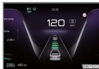
При включении системы помощи при вождении информация этой системы отображается на многофункциональном дисплее. В этом интерфейсе можно запросить информацию о состоянии и аварийных сигналах данной системы.
