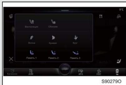
Нажмите кнопку настройки сиденья на передней панели управления системой кондиционирования воздуха, чтобы войти в интерфейс настройки сиденья, в котором можно выбрать режим и уровень массажа сиденья.
