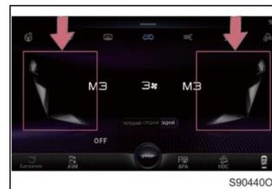
Способ 1: прикоснитесь к индикатору направления ветра, чтобы выбрать соответствующий режим потока воздуха, а для отмены режима прикоснитесь к нему снова. Режимы потоков воздуха можно комбинировать.
