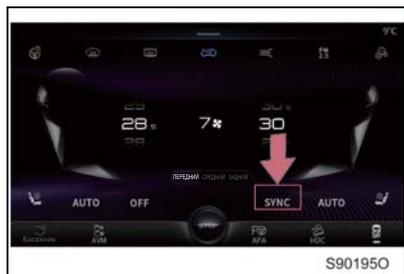
При касании кнопки [SYNC] загорается индикатор и включается режим управления единой температурной зоной, при этом температура и режим обдува на стороне переднего пассажира и в области второго ряда будут синхронизированы с температурой и режимом обдува на стороне водителя.
