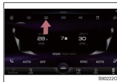
Когда зеркала заднего вида запотели, нажмите кнопку обогрева заднего стекла на панели управления системы кондиционирования воздуха, чтобы обогреть как наружные зеркала заднего вида, так и заднее стекло; при повторном нажатии обогрев отключится.
