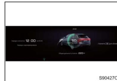
Если время зарядки по таймеру еще не наступило, на панели приборов будет отображаться информация о запланированной зарядке и загорится индикатор
