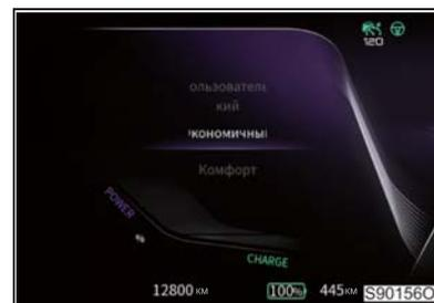
При нажатии кнопки выбора режима вождения на рулевом колесе открывается интерфейс выбора режима вождения. Выбор соответствующего режима вождения осуществляется роликом прокрутки на рулевом колесе. Для подтверждения выбора надо нажать на ролик прокрутки.
