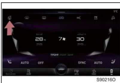
При нажатии кнопки обогрева рулевого колеса на панели управления системы кондиционирования воздуха загорится индикатор и включится функция обогрева рулевого колеса. При повторном ее нажатии функция обогрева рулевого колеса отключится.
