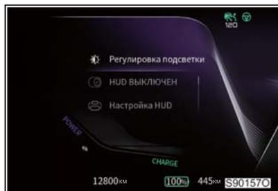
При нажатии кнопки меню на рулевом колесе открывается интерфейс настройки яркости подсветки, проекционного дисплея и наружных зеркал заднего вида.
