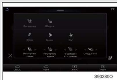
Нажмите кнопку настройки сиденья на дисплее управления системой кондиционирования воздуха заднего ряда, чтобы войти в интерфейс настройки сиденья, в котором можно выбрать режим и уровень массажа сиденья.
