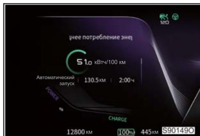
При нажатии левой/правой кнопок выбора происходит переключение между средним энергопотреблением, контролем давления в шинах, информацией о разгоне и запросом информации о неисправности; при нажатии кнопки выбора режима вождения открывается интерфейс выбора режима вождения; при нажатии кнопки меню открывается интерфейс настройки яркости подсветки, проекционного дисплея и наружных зеркал заднего вида.
