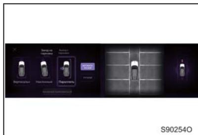
Поиск парковочных мест выполняется в автоматическом или ручном режимах. В каждом режиме имеется три типа парковочных мест: вертикальная парковка, парковка под углом и параллельная парковка.
