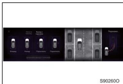
В информационно-развлекательной системе можно выбрать четыре вида выезда с места парковки: вертикально назад, вертикально вперед, параллельно влево и параллельно вправо.
