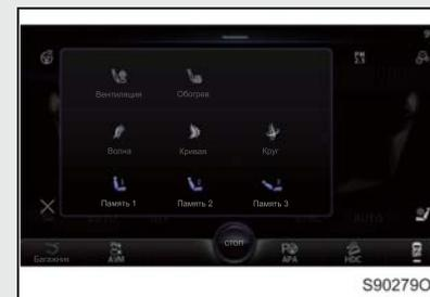
Нажмите кнопку настройки сиденья на передней панели управления системы кондиционирования воздуха, чтобы войти в интерфейс настройки сиденья, нажмите кнопку обогрева и вентиляции сиденья, чтобы выбрать подходящий уровень обогрева и вентиляции.
