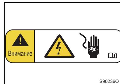
Жгут проводов высокого напряжения и разъемы высокого напряжения обозначены оранжевым цветом. Высоковольтные компоненты (кроме жгутов проводов) отмечены знаками высокого напряжения.
