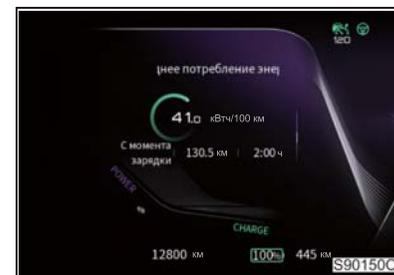
Отображает среднее энергопотребление/пробег/время работы автомобиля в режиме рекуперации.
