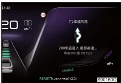
При включении бортового навигационного приложения в области отображения мультимедийной информации появляется текущая навигационная информация.
