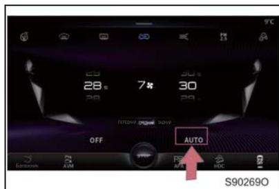
Способ 1: нажмите кнопку [АВТО] на дисплее управления системой кондиционирования воздуха, загорится индикатор и включится автоматический режим кондиционирования воздуха.
