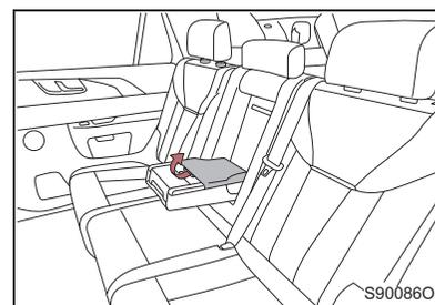
Чтобы открыть отсек для хранения, поднимите его крышку.
