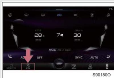
Когда скорость автомобиля ниже 15 км/ч, нажмите кнопку радара/камеры, кнопка загорится и парковочный радар включится. При повторном нажатии кнопки радара/камеры кнопка погаснет и парковочный радар выключится.
