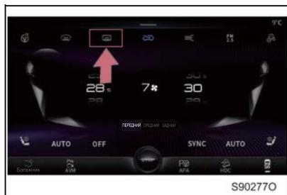
При нажатии кнопки
