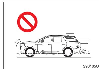
При движении по затопленным дорогам легко причинить неисправности энергосистемы, короткое замыкание электрических компонентов и попадание воды. После отключения энергосистемы не пытайтесь включить переключатель питания (зажигания), иначе это может привести к серьезному повреждению энергосистемы.
