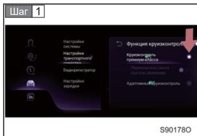
Функцию круиз-контроля можно включить на интерфейсе настроек автомобиля в информационно-развлекательной системе и установить на интеллектуальный адаптивный круиз-контроль (SACC).
