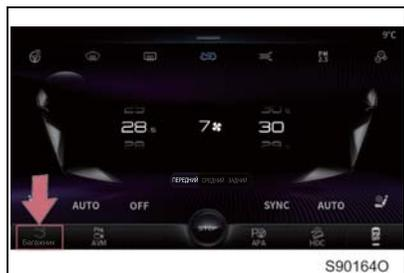
Когда автомобиль неподвижен, и крышка багажника открыта, нажмите и удерживайте внутреннюю кнопку открытия крышки багажника, пока крышка багажника не закроется.
