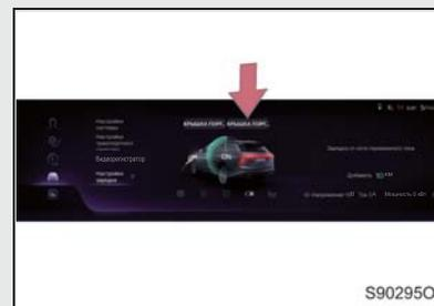
Способ 2: нажмите переключатель крышки гнезда зарядки постоянного тока в настройках зарядки в информационно-развлекательной системе, и крышка гнезда зарядки автоматически откроется.
