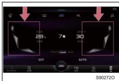
Способ 1: прикоснитесь к индикатору направления потока воздуха, чтобы выбрать соответствующий режим подачи воздуха, а для отмены режима прикоснитесь к нему снова. Режимы подачи воздуха можно комбинировать.
