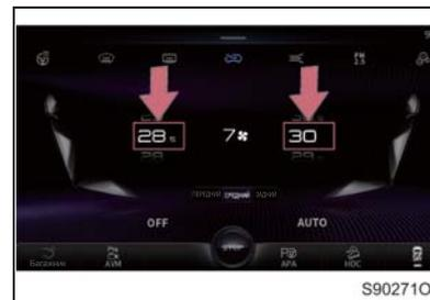
Способ 1: чтобы установить температуру, проведите вверх или вниз по значению настройки температуры на дисплее управления системы кондиционирования воздуха переднего/заднего ряда.
