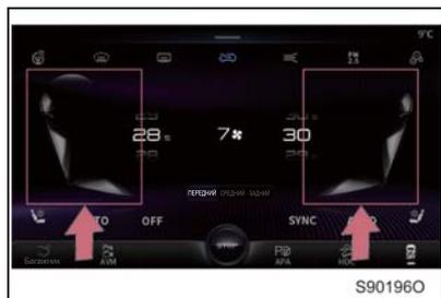
Нажмите кнопку режима потока воздуха, чтобы выбрать соответствующий режим потока воздуха, и нажмите еще раз, чтобы отменить режим потока воздуха; режим потока воздуха можно выбрать в комбинации.
