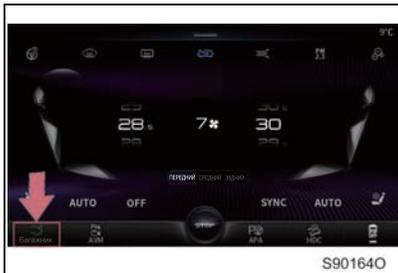
Когда автомобиль неподвижен, и крышка багажника закрыта, нажмите внутреннюю кнопку открытия крышки багажника, чтобы отпереть и открыть ее.
