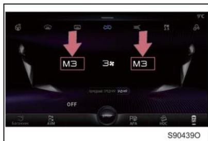
Способ 1: чтобы установить температуру, проведите вверх или вниз по значению настройки температуры на дисплее управления передней системы кондиционирования воздуха.
