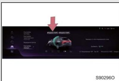
Способ 2: нажмите переключатель крышки зарядного гнезда переменного тока в настройках зарядки в информационно-развлекательной системе, и крышка зарядного гнезда автоматически откроется.
