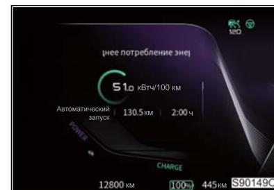
Отображает среднее энергопотребление/пробег/время работы автомобиля с момента его запуска.
